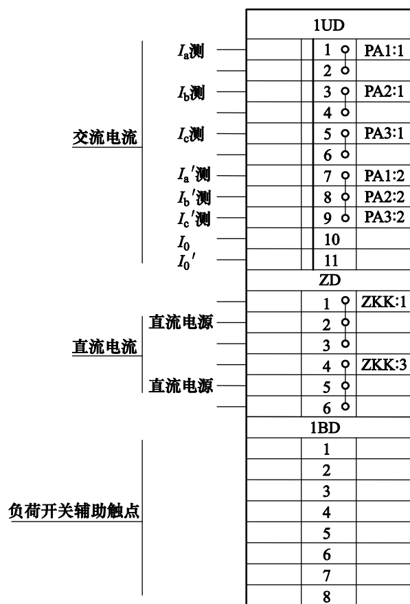
图1 进、出线柜端子排图
