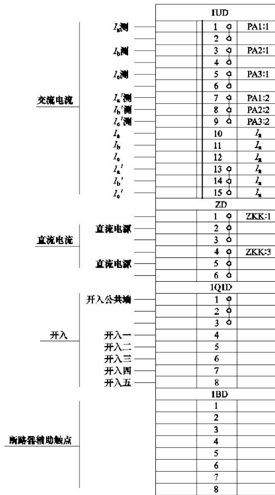
图 2 断路器柜端子排图
