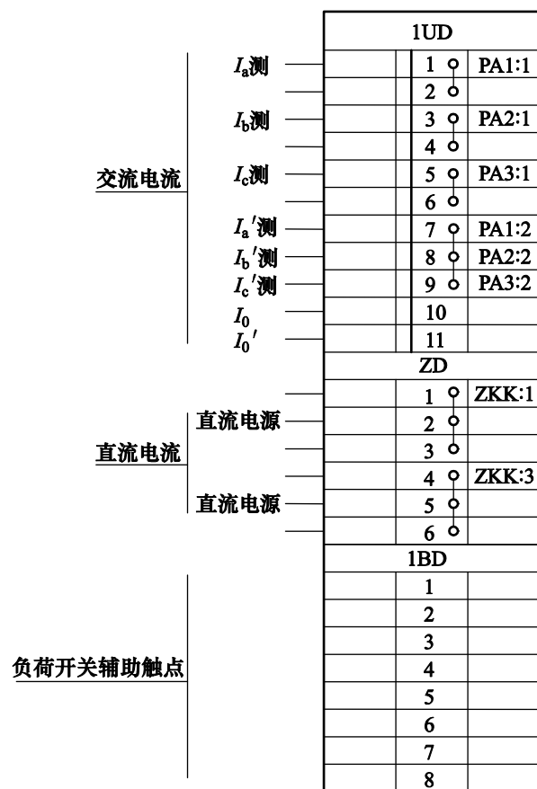
图1 进、出线柜端子排图
