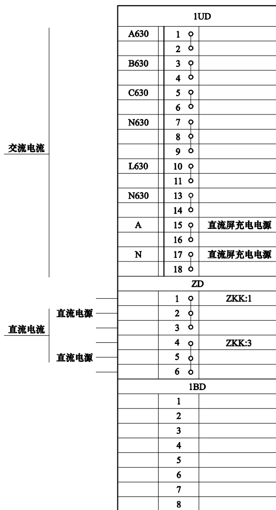
图3 电压互感器柜端子排图
