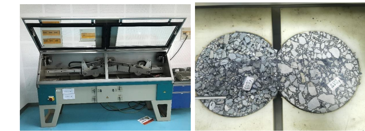
图 3.6-7 路面芯样汉堡车辙试验
