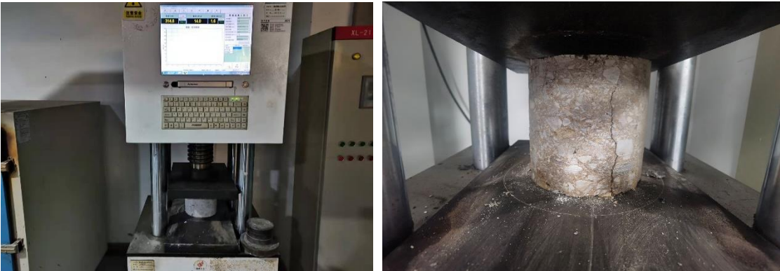
图 3.6-14 基层无侧限抗压强度检测
