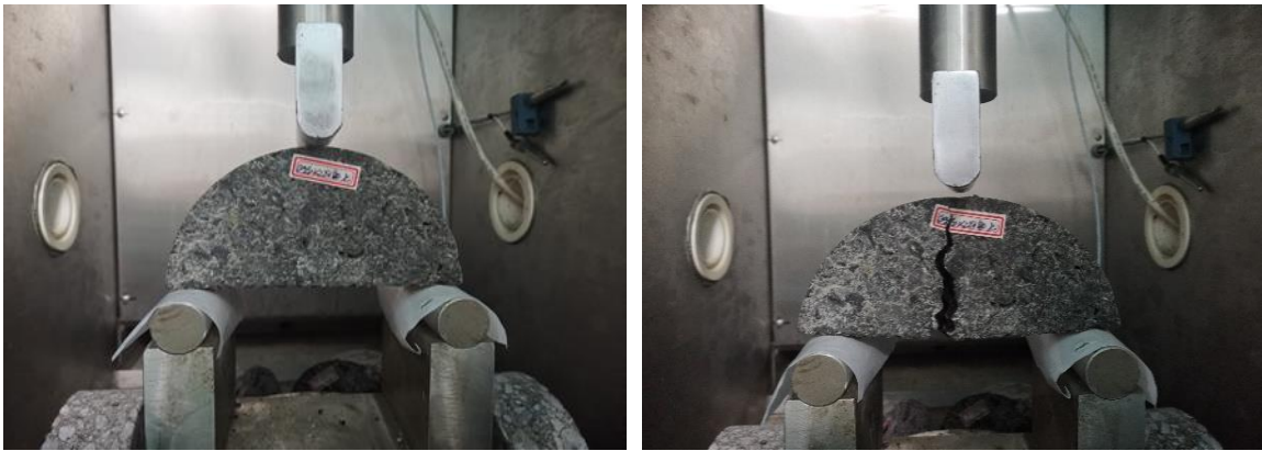
图 3.6-12 低温半圆弯曲破坏示意图
